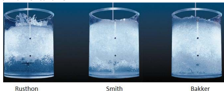
Figur 13 Gas spredning for Rushton, Smith og Bakker turbinerne [41]
