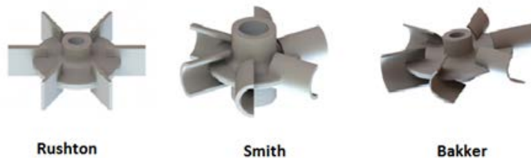
Figur 12 Rushton, Smith og Bakker turbiner [41]
